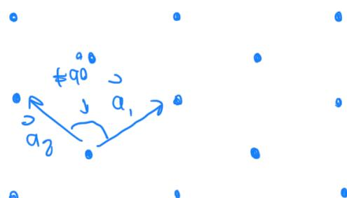
5 Oblique lattice:  $|\vec{a}_1| \neq |\vec{a}_2|$   $\gamma \neq 90^\circ$
